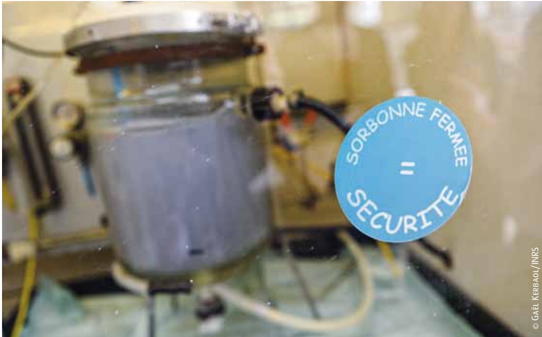
Après un temps de chauffe et d'agitation, le produit décante et le réacteur est vidangé.
