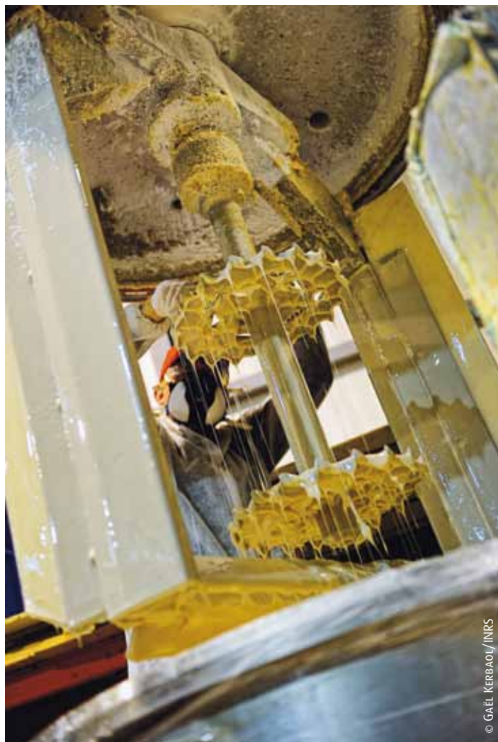
La machine multimix, qui comprend une turbine centrale et une pale racleuse, est nettoyée entre chaque préparation.
