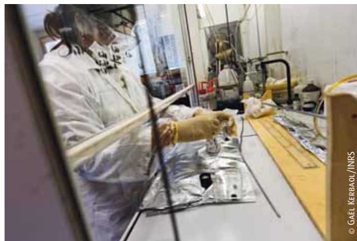
Les opérations de synthèse et de collecte des nanotubes de carbone ont lieu sous une sorbonne.
