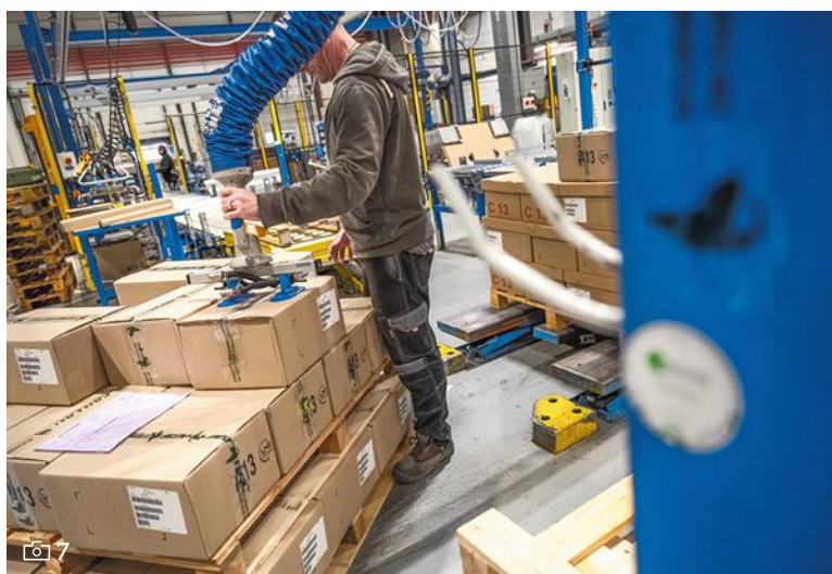
7. ... TANDIS QUE d'autres préfèrent utiliser un préhenseur à ventouses pour les cartons classiques (ceux qui ne sont pas en cloche).
