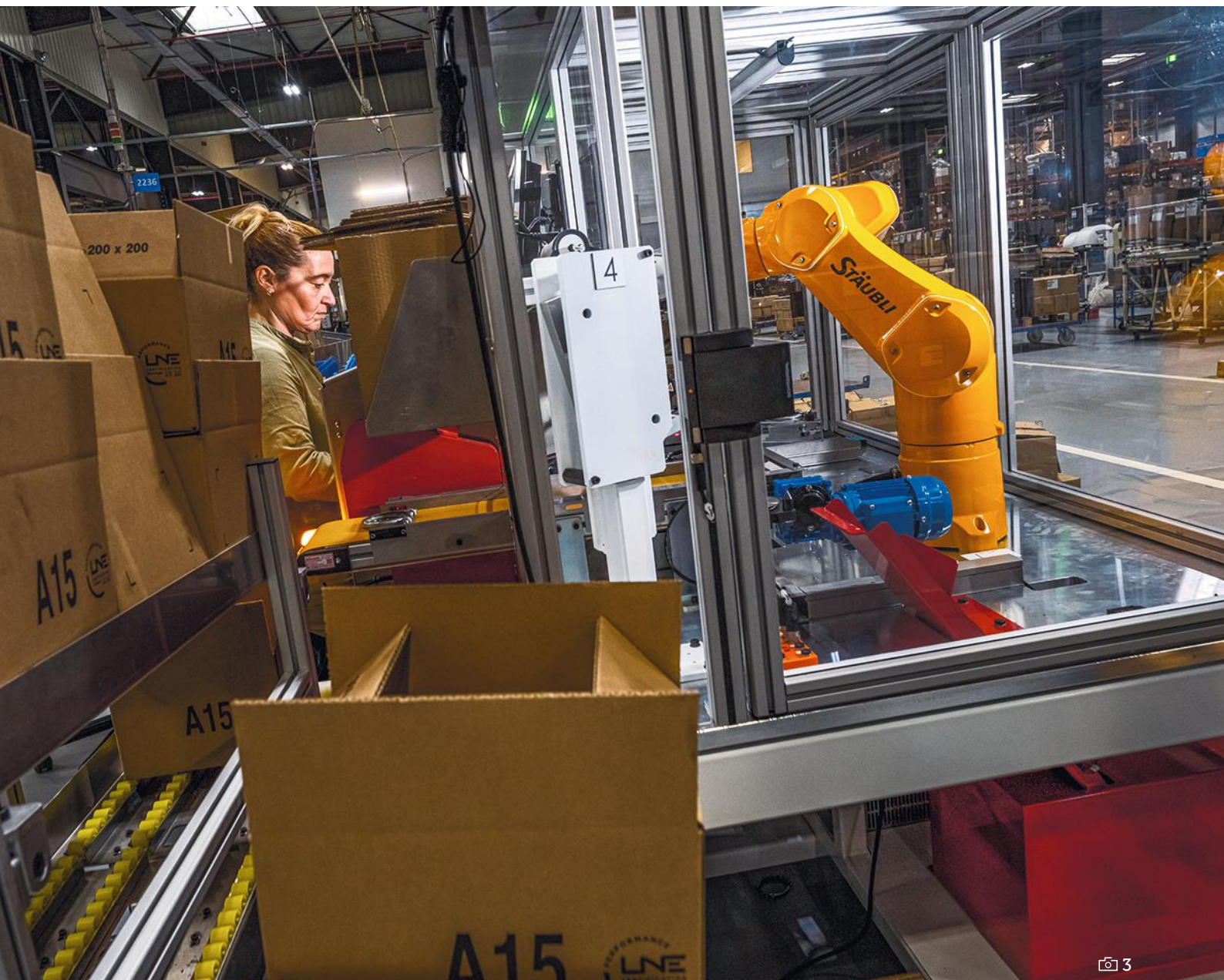
3. LE POSTE D'ASSEMBLAGE 2249 a fait l'objet d'une étude ergonomique et a été entièrement repensé pour limiter notamment les torsions du buste de l'opératrice. Désormais, les cartons de composants sont renversés dans un bac se situant devant elle, pour qu'elle travaille à la bonne hauteur, sans torsion du buste, et assise si elle le souhaite.
