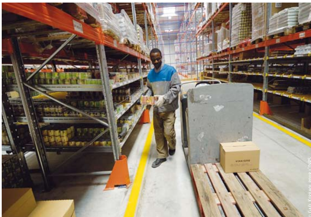
Les rayonnages dynamiques chargés par l'arrière permettent de stocker un grand nombre de références et facilitent le prélèvement des articles.
