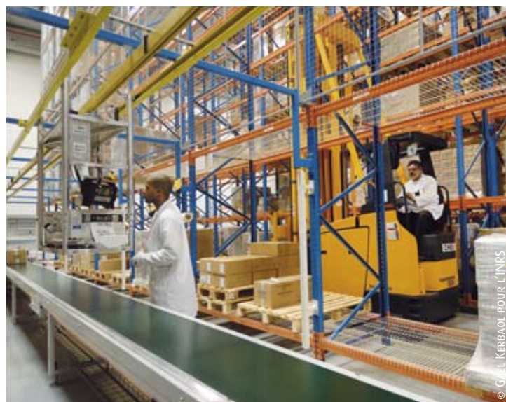
Au premier plan, l'allée de préparation de commandes équipée d'un convoyeur à bande et d'un terminal de gestion. Au second plan, derrière le palettier, le chariot de manutention des palettes circule dans une travée dédiée à la circulation d'engins.
