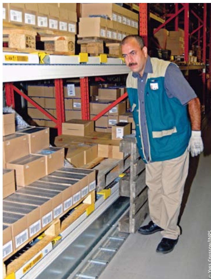
Photo de droite : Un système de rouleaux au sol permet de faire glisser les palettes sans avoir à les porter.
