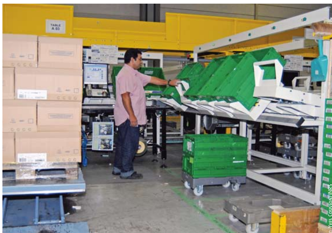
Photo ci-dessous : Les basculeurs facilitent le remplissage des bacs de commandes, puis leur évacuation sur le convoyeur.
