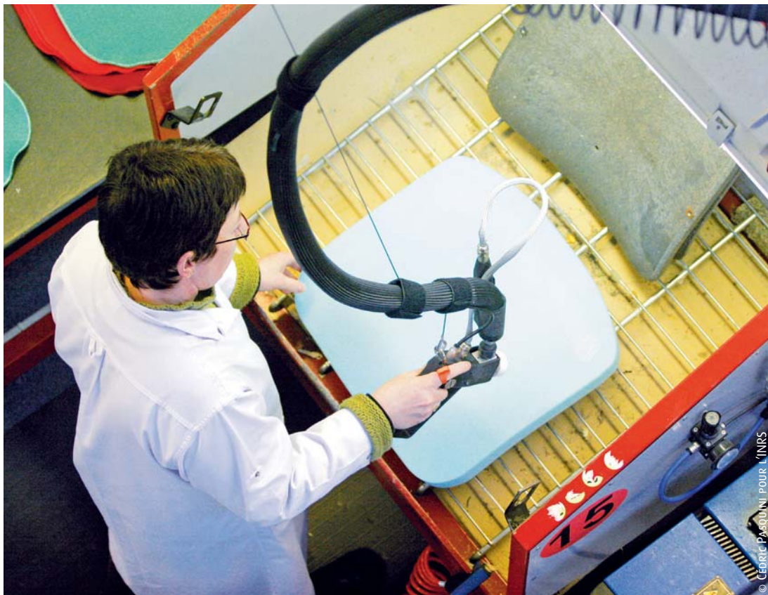
Atelier tapisserie. Chaque face de la mousse est encollée et appliquée d'un côté sur un support rigide et de l'autre sur le revêtement. Le pressage qui suit assure la tension des tissus.
