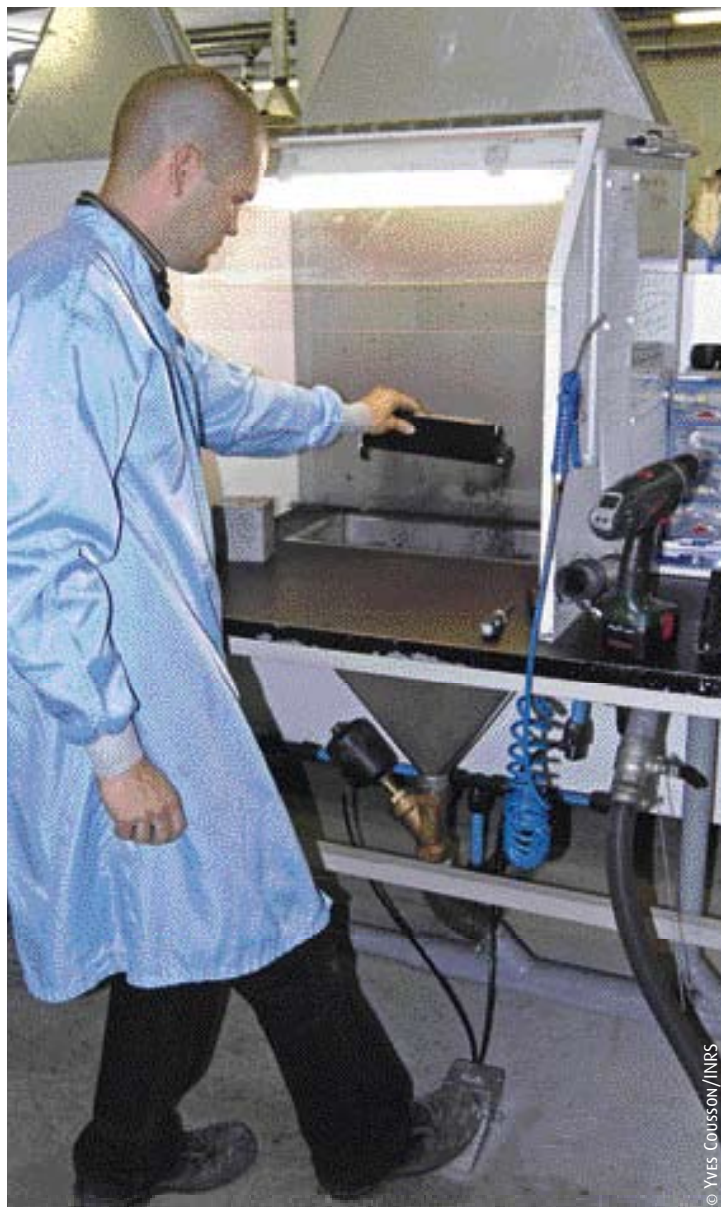
L'opérateur vide la cartouche de toner tout en appuyant sur une pédale afin d'augmenter le débit d'air et d'évacuer la matière.
